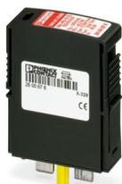
ÜSG Typ 1, UL Recognized, und Überspannungsschutzstecker IEC Typ 2 mit Varistor und thermischer Abtrennvorrichtung für die Verwendung mit VAL-US-Basiselementen, mechanische und optische Defektmeldung
