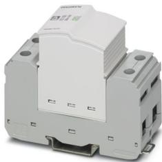
Steckbarer Blitzstromableiter, gem. Typ 1 / Class I, für 1-phasige Stromversorgungsnetze mit kombiniert verlegtem PE und N in einem Leiter (L1, PEN).
