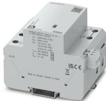
Kompakter, nicht-steckbarer und leckstromfreier Blitzstrom- / Überspannungsableiter auf Basis verschleißfreier Carbon-Funkenstreckentechnologie für 3-phasige Stromversorgungsnetze mit separatem N und PE (5-Leitersystem: L1, L2, L3, N, PE), geeignet für den Einsatz im Vorzählerbereich, Ableitvermögen bis 100 kA für die Blitzschutzklassen I und II, mit Fernmeldung.
