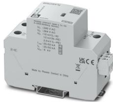
Kompakter, nicht-steckbarer und leckstromfreier Blitzstrom- / Überspannungsableiter auf Basis verschleißfreier Carbon-Funkenstreckentechnologie für 1-phasige Stromversorgungsnetze mit separatem N und PE (3-Leitersystem: L1, N, PE), geeignet für den Einsatz im Vorzählerbereich, Ableitvermögen bis 100 kA für die Blitzschutzklassen I und II, mit Fernmeldung.
