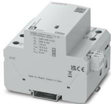
Kompakter, nicht-steckbarer und leckstromfreier Blitzstrom- / Überspannungsableiter auf Basis verschleißfreier Carbon-Funkenstreckentechnologie für 3-phasige Stromversorgungsnetze mit gemeinsamen N und PE (4-Leitersystem: L1, L2, L3, PEN), geeignet für den Einsatz im Vorzählerbereich, Ableitvermögen bis 50 kA für die Blitzschutzklassen III und IV, mit Fernmeldung.
