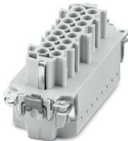
Kontakteinsatz, Polzahl: 16+2 PE, Baugröße: B16, Anzahl der Anschlüsse je Pol: 1, Buchse, Push-in-Anschluss, 500 V, 16 A, 0,14 mm<sup>2</sup> ... 2,5 mm<sup>2</sup>, Anwendung: Leistung, werkzeuglose Click-in-Montage
