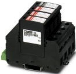
Universeller steckbarer Blitzstromableiter auf Varistorbasis für 3-phasige Stromversorgungsnetze mit separatem N und PE (5-Leitersystem: L1, L2, L3, N, PE), für die Blitzschutzklassen III und IV, mit Fernmeldekontakt.
