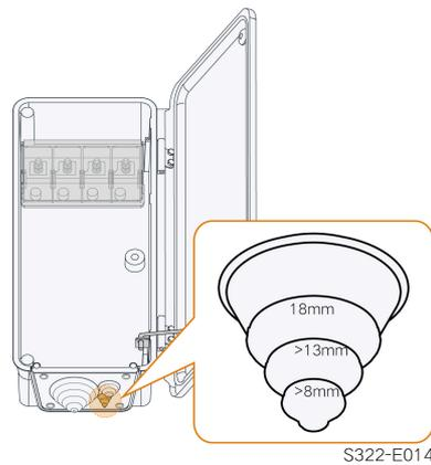
**step 3** Führen Sie das Kabel durch den Dichtungsring. Die Länge des nicht abisolierten Kabels im Wechselstrom-Anschlusskasten beträgt 50 mm.
